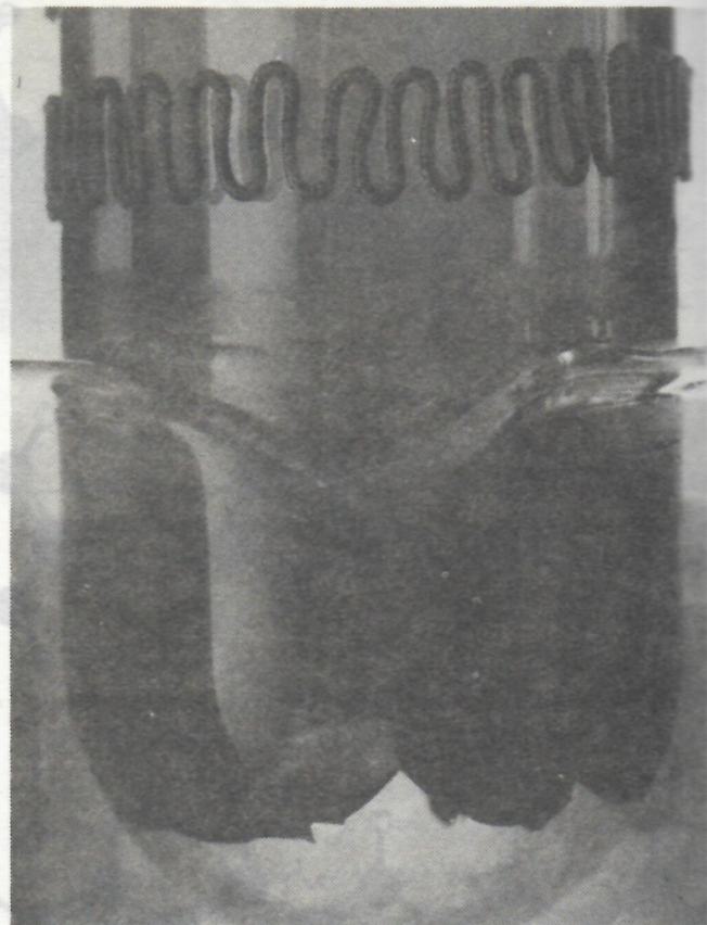
شکل ۱. سنتز پلی استیلن با تغییر رنگ همراه است. این بسیار بر اثر دوپه کردن قابلیت رسانایی برق را پیدا می‌کند. موقعی که بسیارش روی دیواره‌های ظرفی شیشه‌ای انجام می‌گیرد، ورقه نازک بسیار بر اثر نور عبوری قرمز رنگ است و وقتی این ظرف حرارت داده شود رنگ به آبی بر می‌گردد. در اینجا به وسیله بخ خشک (در پایین شکل) و گرمکن (در بالای شکل) پلی استیلن را در دو دمای مختلف نگه داشته‌ایم تا تغییر رنگ را نشان دهیم. ورقه‌های ضخیمتر نظیر آنچه که در شکل ۵ نشان داده شده به جای عبور دادن نور، نور را منعکس می‌سازد و مثل یک فلز می‌درخشد. (به شکل پشت جلد مجله مراجعه کنید.)
